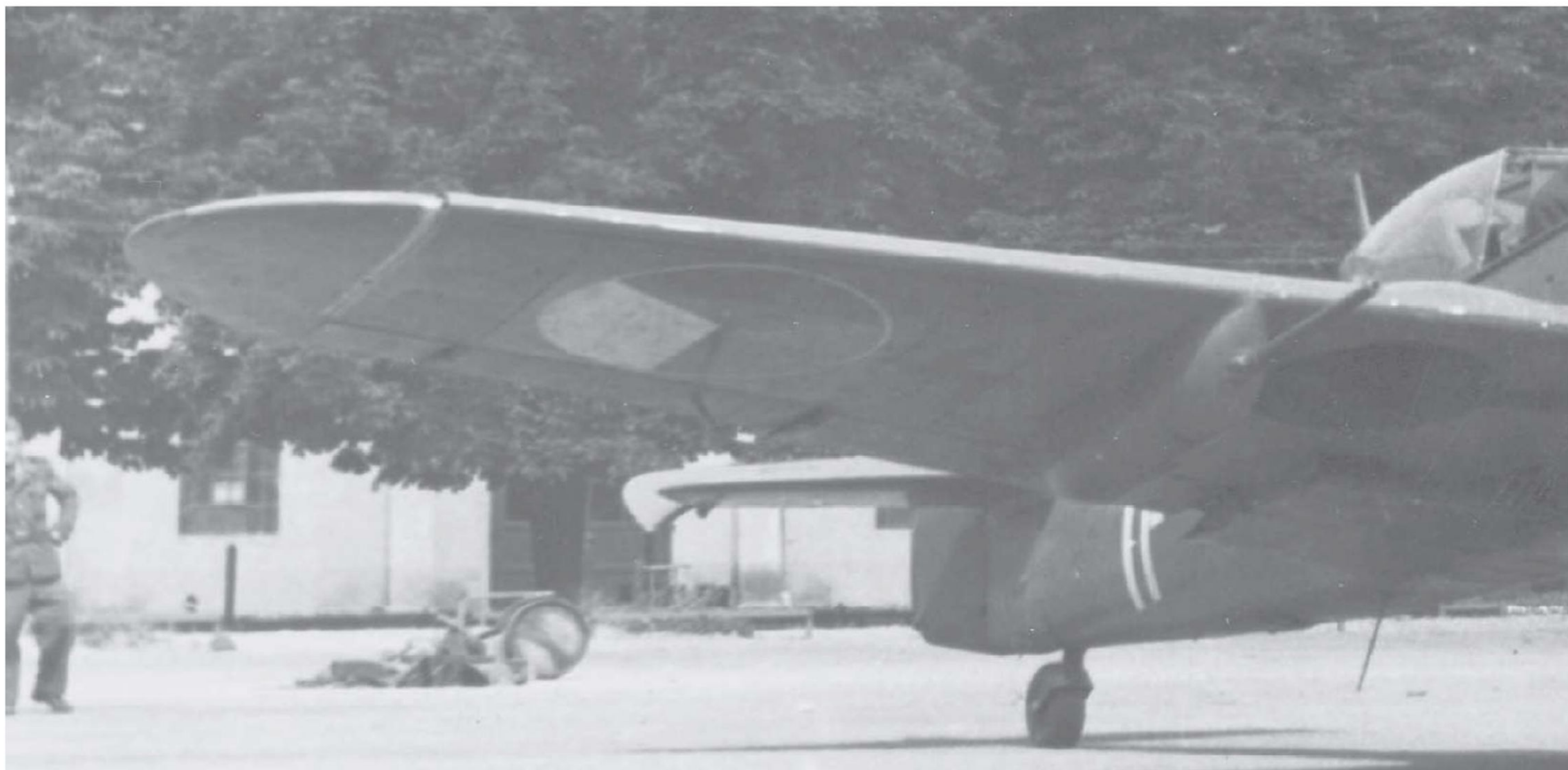
Fenoménn proužků na koncích křídla: Na detailním snímku S-199.185 se znaky IF-01 není ještě krycí proužek plátu v místě žebra č. 13 aplikován (nebo je naopak stržen), zatímco na zimním snímku z Plzně (znaky SO patřily 4. lp, konkrétně jeho 3. letce) je již přetřen a má poněkud tmavší odstín.
