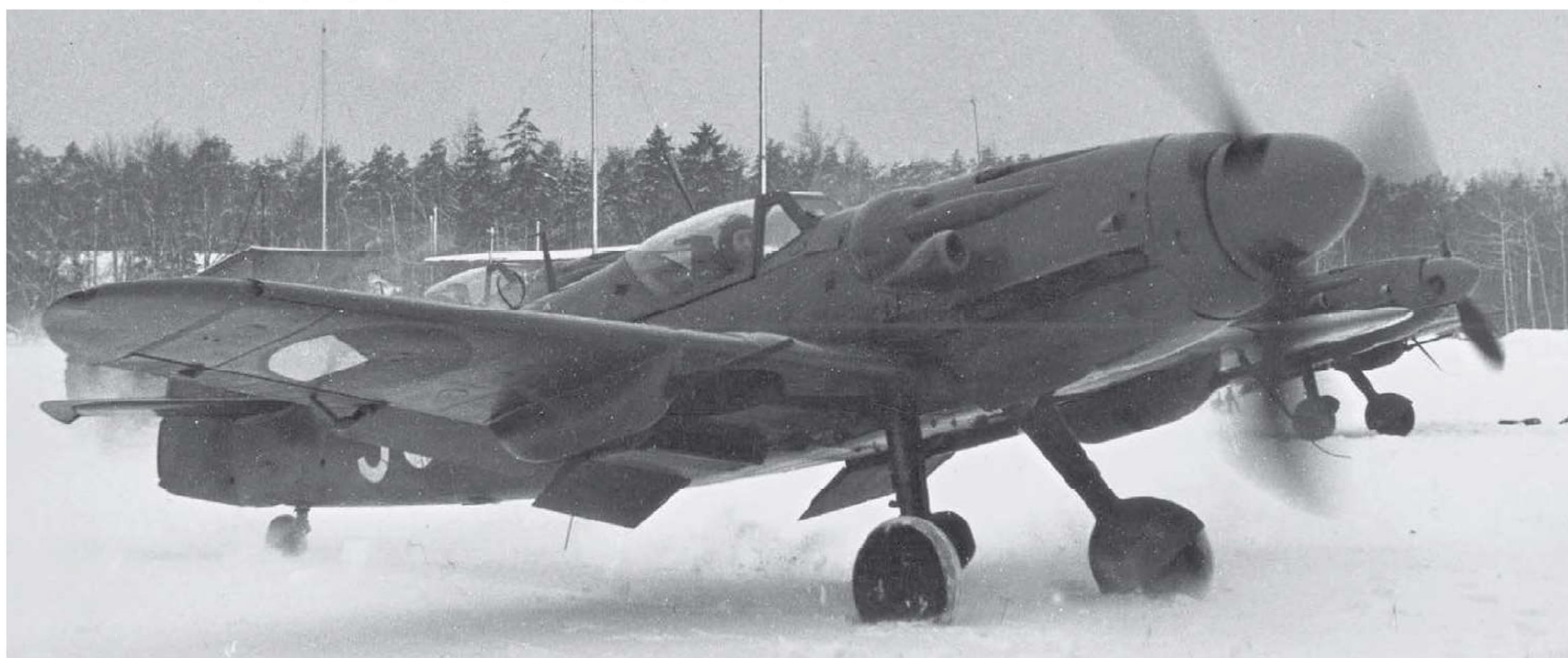
Fenoménn proužků na koncích křídla: Na detailním snímku S-199.185 se znaky IF-01 není ještě krycí proužek plátu v místě žebra č. 13 aplikován (nebo je naopak stržen), zatímco na zimním snímku z Plzně (znaky SO patřily 4. lp, konkrétně jeho 3. letce) je již přetřen a má poněkud tmavší odstín.
