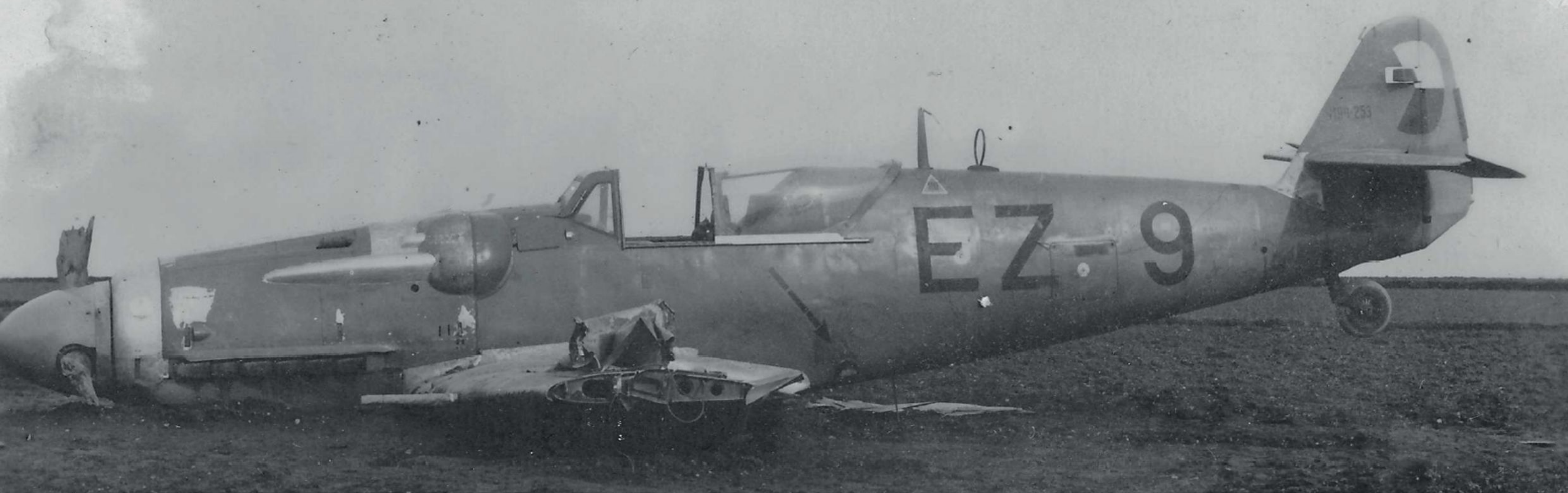
V textu článku zmíněná povrchově atraktivní Avia S-199.253, „černá“ EZ-9, patří 3. letce LP 5 v Plané u Českých Budějovic. Toto vynucené přistání provedl a poškození křídla a spodní části trupu zavinil dne 25. února 1950 u Červeného Hrádku u Plzně rt. Jiljí Horák. Za povšimnutí stojí nenabarvené části plechů na přídi, motorovém krytu a vyměnitelný tvarovaný kryt přechodu trup – kýlovka. Letoun má rovněž (velmi) tenký modrý lem výsostných znaků na SOP. Zajímavostí jsou rovněž návleky na trupových a křídelních kulometech.
