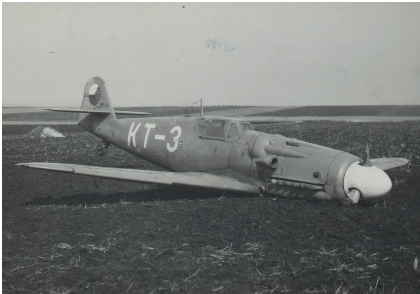
S-199.310 z produkce firmy Aero. Dne 30. 5. 1949 s tímto letounem s trupovými znaky KT-3, které jej zařazují k 3. letce 7. leteckého pluku (LP 7 „Invační“) 3. ld, vynuceně přistál nedaleko Boskovic pilot rt. Karel Kessler. Tato S-199 má pouze dva synchronizované kulomety vz. 131/13N v trupu, v křídle kulomety instalovány nejsou. Během opravy po nehodě byl letoun vybaven novým, vzad odsunovatelným překrytem kabiny (bublinou), byl upraven na průzkumný a přidělen k LP 1. V roce 1951 byl ve stavu 5. leteckého školního pluku ve Zvolenu, kde dostal černý kód UL-51 a žluté školní identifikační doplňky. S největší pravděpodobností u LU již létal bez fotovybavení.
