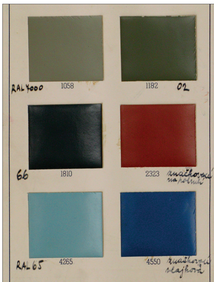
Reprodukce jednoho listu vzorníku odstínů Spojených továren na barvy a laky, n. p., z roku 1950, se zachovanými originálními doplňujícími poznámkami. V horní řadě jsou odstíny světlé šedozelené (ekvivalent RAL) a Avion 2036.02 (RLM 02), v pravém dolním rohu pak odstín modré barvy pro výsostné znaky (značkovácí vlajková). Číslo 66 značí odstín původní černošedé RLM 66 (pro interiéry, podvozkové šachty) a RAL 65 odpovídá odstínu barvy pro spodní plochy (Avion 2036.65)
